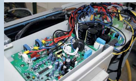
Инновационная система управления и DC инвертор
